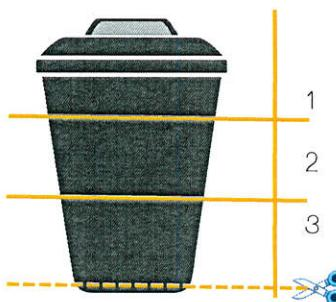
2. ขุดหลุมและนำถังผึ้งดินลึก 2 ใน 3 ส่วนของถัง และกันถังอยู่เหนือกันหลุม 30 เซนติเมตร
